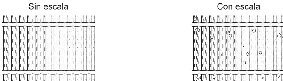
Si puede comprobar visualmente que la escala blanca (escala) sólo se encuentra en el elemento de refrigeración, puede retirar el elemento de refrigeración de la unidad de refrigeración y lavarlo.
